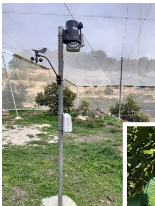
Estación agrometeorológica instalada bajo la malla.
