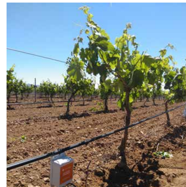
Imagen 1: InnoBobal. Equipo de monitorización de humedad del suelo instalado en parcela.
