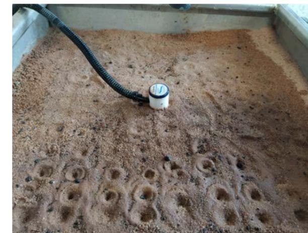
**Abajo izquierda, sensores capacitivos instalados en olivo superintensivo. Arriba, sonda instalada en el depósito de suelo arenoso y abajo derecha, posterior muestreo de suelo inalterado en el radio de medida de la sonda.**
